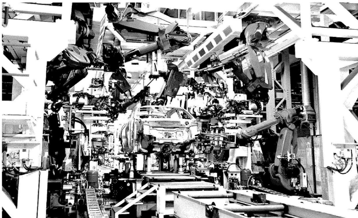
**La carica dei cinquecento.** La realizzazione di Comau prevede oltre 500 robot per la produzione della Alfa Romeo Tonale e di altre vetture del gruppo Stellantis.
